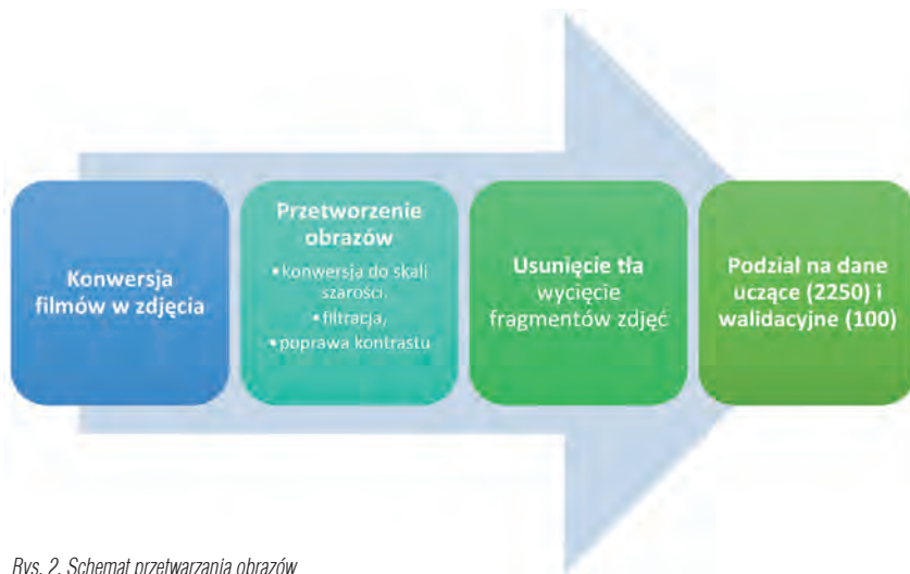
Rys. 2. Schemat przetwarzania obrazów
