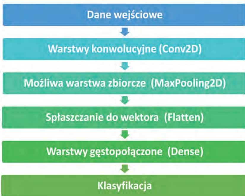
Rys. 4. Schemat budowy zaproponowanej sieci neuronowej służącej do rozpoznawania rodzajów przepływów
