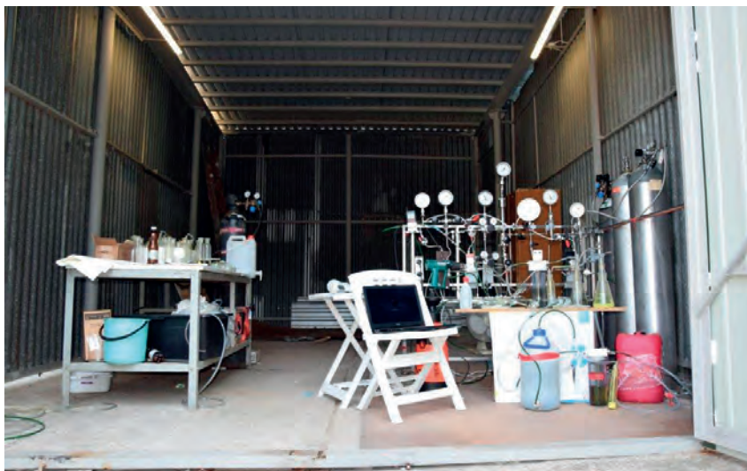
Rys. 2. Widok zestawu pomiarowego membranowej instalacji odsiarczania gazu
