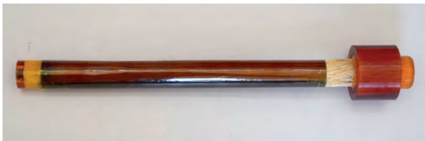
Rys. 1. Zdjęcie wiązki kapilarnych membran poliimidowych zestawionych w moduł
