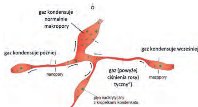
Rys. 5 Początek procesu kondensacji w nanoporach dla przypadku uwzględniającego przesunięcie krzywej nasycenia (Alharthy et al., 2013)
