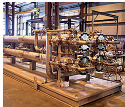
Fot. 2. Instalacja do usuwania H_2S z gazu ziemnego firmy MTR
