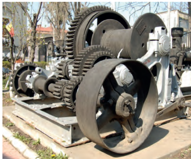
Pompa płuczkowa Peiner (1925) i wyciąg Peine-Lemoine (1930). Arch. Muzeum Ropy w Ploeszti
