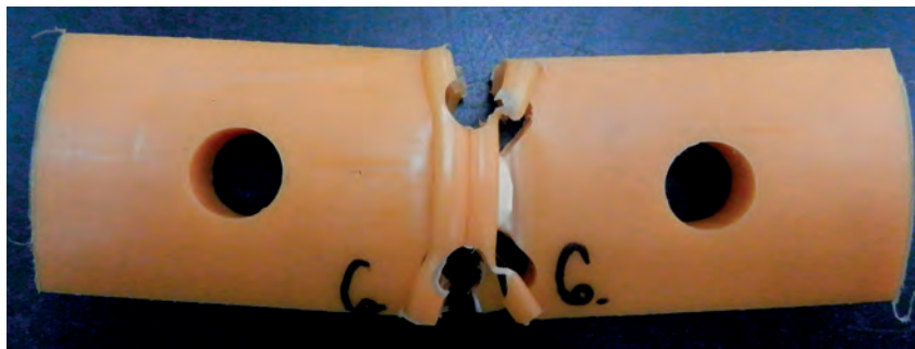
Fot. 3. Próba po badaniu wytrzymałości na rozciąganie zgrzewu doczołowego rur PE
