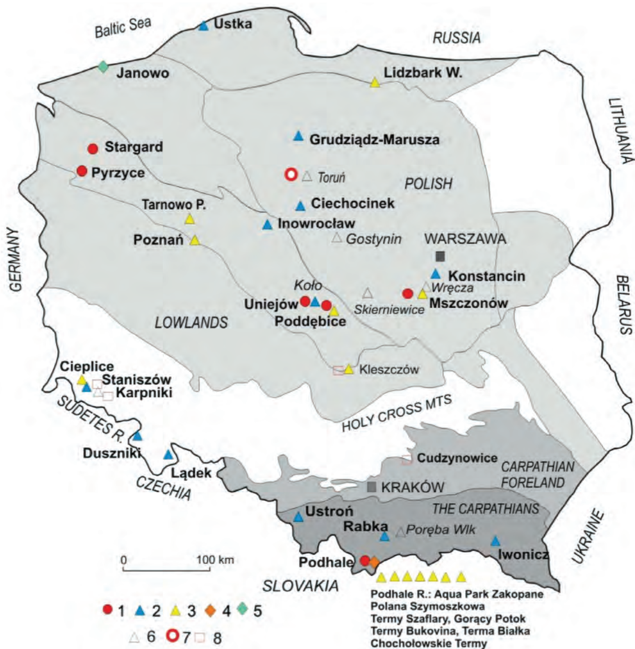
Fig. 1. Wykorzystanie energii geotermalnej w Polsce (stan na rok 2018); 1 – ciepłownia, 2 – uzdrowiska, 3 – ośrodki rekreacyjne, 4 – suszarnie drewna, 5 – hodowla ryb, 6 – ośrodki rekreacyjne w realizacji, 7 – ciepłownia w realizacji, 8 – indywidualne systemy grzewcze (Kępińska 2020)
