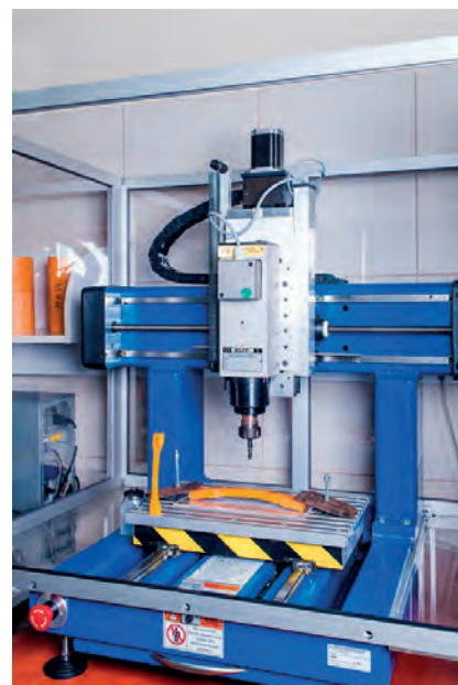
Fot. 1. Frezarka CNC do przygotowywania próbek do badania wytrzymałości na rozciąganie
